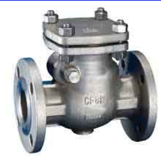
RVS terugslagklep PN16 RVS zitting / metaaldichtend huis : RVS 1.4408 / 316 temp. : -30°C +200°C fig 764 : PN16 / DN40 - DN300 inbouw lengte volgens DIN 3202 F6 flenzen volgens PN16 RF
