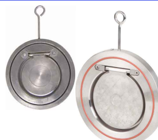
terugslagklep tussenbouwtype enkelplaat tussenbouw tussen flenzen PN10/16 - 150 lbs max. druk : 16 bar tot DN200 / 10 bar > DN200 DN40 - DN600 fig 783 : RVS 316 huis en klep / viton dichting temp. : -10°C +180°C fig 782 : stalen huis en klep / EPDM dichting temp. : -10°C +110°C fig 782NBR : stalen huis en klep / NBR dich. temp. : -10°C +80°C
