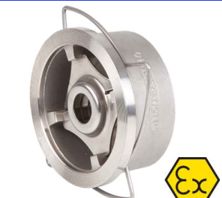
stalen terugslagklep met flapper / zonder veer RVS zitting / metaaldichtend huis : staal GS-C25 / GP240GH temp. : -20°C +425°C fig 755 : PN16 / DN40 - DN600 fig 756 : PN25 / DN40 - DN600 fig 757 : PN40 / DN50 - DN500
