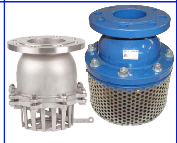
voetkleppen met filterzeef PN16 fig 795 : gietijzeren huis / stalen zeef temp. : -10°C +90°C PN16 : DN50 - DN300 fig 797 : RVS 316 huis en zeef temp. : -25°C +150°C PN16 : DN50 - DN200 manueel leegloop-hendel viton zitting / telfon dichtingen
