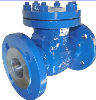
stalen terugslagklep met flapper / zonder veer RVS zitting / metaaldichtend huis : staal GS-C25 / GP240GH temp. : -20°C +425°C fig 755 : PN16 / DN40 - DN600 fig 756 : PN25 / DN40 - DN600 fig 757 : PN40 / DN50 - DN500
