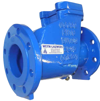
nodulair gietijzeren terugslagklep PN10/16 met NBR rubber flapper / zonder veer fig 752 : DN40 - DN400 NBR rubberen klep temp. : -10°C +80°C inbouw lengte volgens DIN 3202 F6 flenzen volgens PN16 RF huis : nodulair gietijzer GGG40 / GJS400
