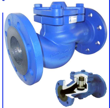
RVS klep - veer en zitting fig 760 : gietijzer PN16 : DN 15 - DN200 temp. : -10°C +300°C fig 761 : staal PN40 : DN 15 - DN200 fig 762 : staal PN63 : DN 15 - DN200 fig 763 : staal PN100 : DN 15 - DN200 temp. : -20°C +400°C fig 765 : RVS 316 PN40 : DN 15 - DN200 temp. : -30°C +400°C
