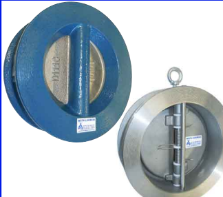
terugslagklep tussenbouwtype dubbelplaat tussenb. ts. flenzen PN10/16 ( fig 786 : PN25) max. druk : 16 bar tot DN300 / 10 bar > DN300 DN50 - DN600 fig 786T : RVS 316 huis en klep/viton dichting temp. : -10°C +200°C fig 785 : gietijzer huis/RVS klep / EPDM dicht. temp. : -10°C +110°C fig 785T : gietijzer huis en klep / NBR dichting temp. : -10°C +80°C
