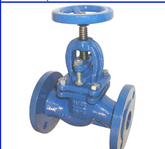
fig 490 : vergrendelbare terugslagklep PN16 DN15 - DN3000 huis : gietijzer bronzen klepafdichting en zitting stijgende spindel en handwiel temp. : max -10°C +225°C inbouw lengte volgens din 3202 F1 spindel naar beneden gedraaid wordt de terugslagklep vergrendeld in gesloten stand
