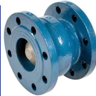
gietijzeren terugslagklep PN16 veerbelast / epoxy coating DN50 - DN300 fig 787 : gietijzeren disc NBR dichting temp. : -10°C +80°C fig 787T : RVS 304 disc EPDM dichting temp. : -10°C +110°C
