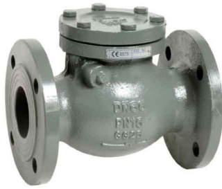
gietijzeren terugslagklep PN16 met flapper / zonder veer fig 750 : DN40 - DN200 EPDM rubber beklede klep temp. : -10°C +90°C inbouw lengte volgens DIN 3202 F6 flenzen volgens PN16 RF fig 751 : DN40 - DN500 metaaldichtend PN10/16
