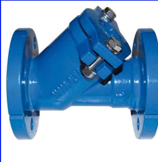
nodulair gietijzeren balkeerklap PN16 huis : GGG40 met epoxy coating bal met NBR rubber coating temp. : -10°C +80°C fig 772 : PN16 / DN40 - DN400 inbouw lengte volgens DIN 3202 F6
